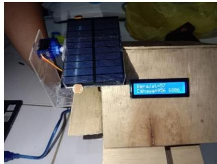
Gambar 5 Hasil Alat Solar Tracker Dengan Interupsi Eksternal
