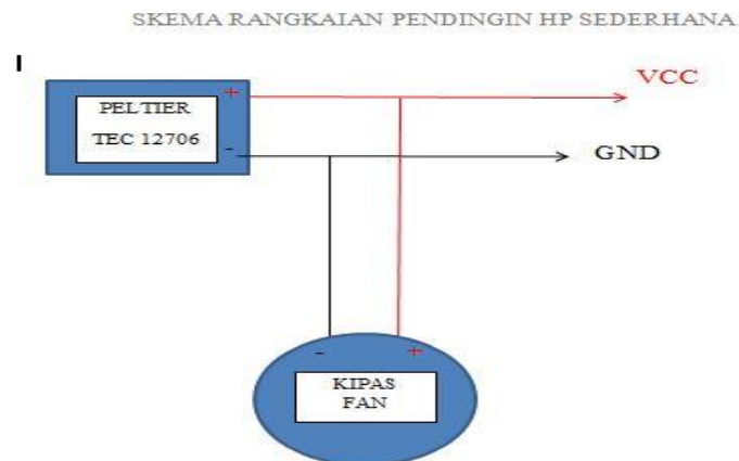
Gambar 4. Skema Rangkaian Colling Fan
